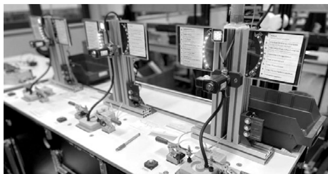
Technisches Highlight: Prüfstation mit In-line-Prüfkonzept
