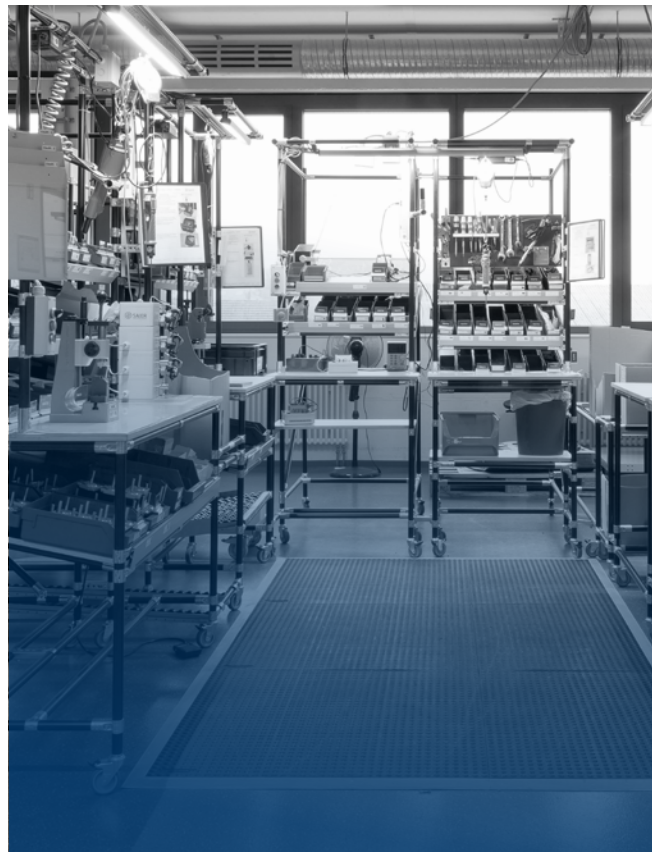
Anpassung der Arbeitsplatzsituation: Arbeitssysteme sind nach dem Prinzip One-piece-flow aufgebaut.
