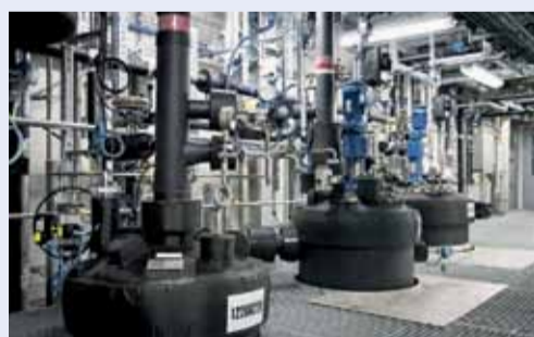
Lignocellulose-Bioraffinerie des Fraunhofer CBP: Reaktoren zur Fällung von Lignin. Foto: Fraunhofer CBP, Leuna
